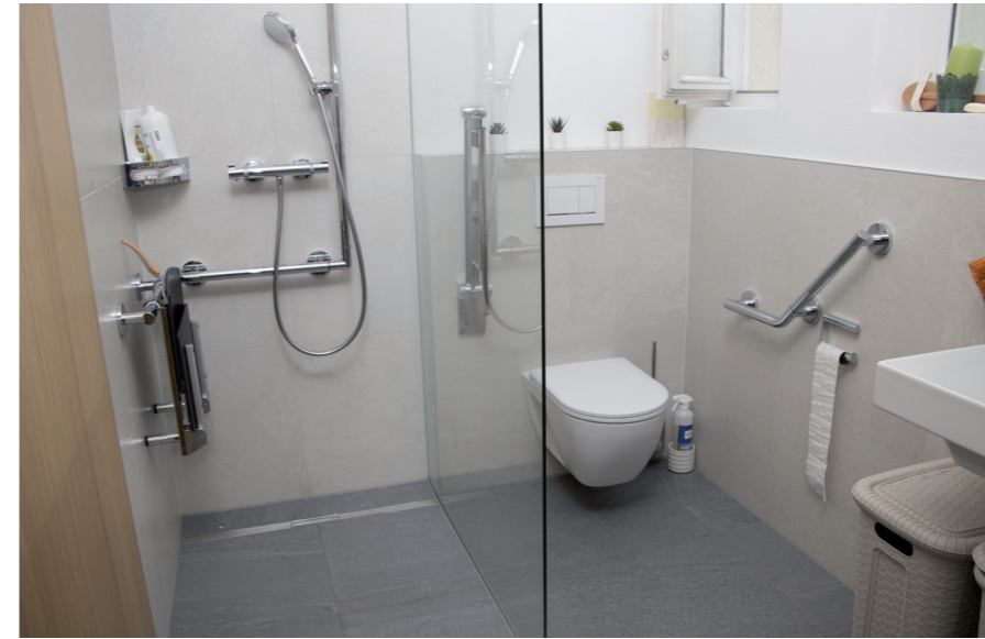
Das sanierte Bad mit stufenloser Dusche, Haltegriffen und ausreichend Platz, falls ein Rollstuhl notwendig wird. Der Treppenlift schafft barrierefreien Zugang von der Garage bzw. dem Keller in den Wohnraum der Familie Hämmerle.
